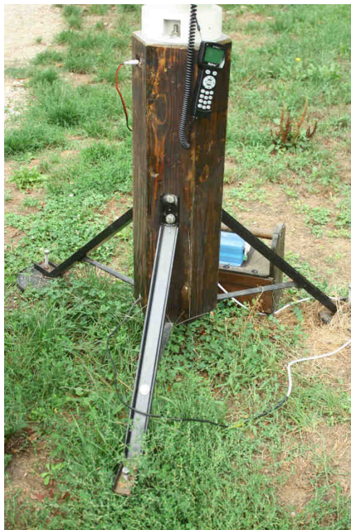
Pied lourd environ 100kg tube creux hexagonal en béton rempli en son centre de sable anti vibration, démontable et transportable, le moule bois, protégé à la cire d'abeille, est laissé pour l'esthétique...
